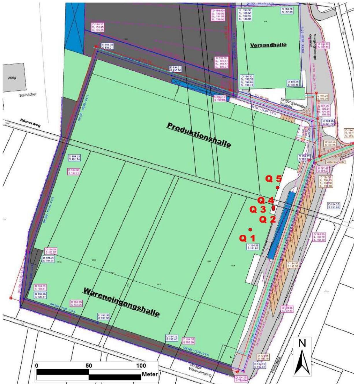
Abb. 6.1: Quellenplan: Q1 Wäscher, Q2 Rauchgas Verzinkung (Ofen), Q3 Rauchgas Ver-zinkung (Kessel) Q4 Rauchgas Heizkessel Vorbehandlung, Q5 Trockner.
