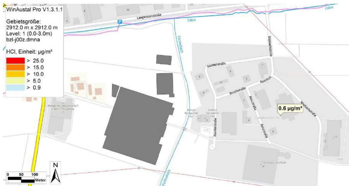
Abb. 8.1: Berechnete Zusatzbelastung für HCl in  $\mu\text{g}/\text{m}^3$ , Kartengrundlage © Bundesamt für Kartographie und Geodäsie 2018, [http://sg.geodatenzentrum.de/web\\_public/Datenquellen\\_TopPlus\\_Open.pdf](http://sg.geodatenzentrum.de/web_public/Datenquellen_TopPlus_Open.pdf) ergänzt um geplante Gebäude der Firma Layher
